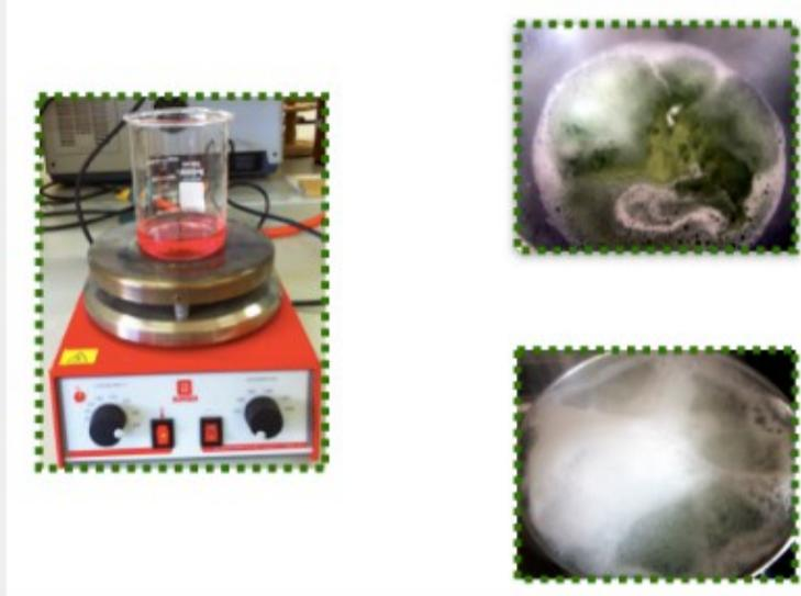
En un laboratorio correctamente adaptado hay diversas maneras para realizar dicho proceso. Una de ellas es mediante el REFLUJO, donde con una placa calefactora, aumentamos la temperatura de la sustancia en estado líquido, hasta alcanzar su punto de ebullición. A dicha temperatura comienza a producirse vapor que asciende por la columna y podemos posteriormente condensarlo de nuevo para recogerlo si nos interesa.
