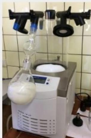
Con la LIOFILIZACIÓN podemos eliminar el agua presente en disoluciones debido a las condiciones de baja presión y de baja temperatura que nos facilita el equipo. El agua presente se elimina por congelación y posterior sublimación del hielo. Al suministrar calor el hielo pasa de su fase sólida a la gaseosa sin alcanzar el punto de ebullición del agua y por tanto sin pasar por la fase líquida.
