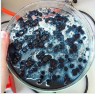
La cristalización es una técnica muy empleada en el laboratorio para purificar sustancias que normalmente contienen impurezas. Una sustancia que cristaliza fácilmente es el  $\text{KH}_2\text{PO}_4$  (fosfato monopotásico) tras realizar una solución saturada de dicho compuesto con agua caliente.
