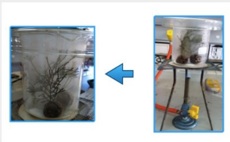
Si ponemos en contacto al vapor obtenido en la sublimación con una superficie fría, como una tapadera, el ácido benzoico experimenta una sublimación inversa formando cristales de elevada pureza.
